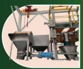
Bag dump station is designed to handle small bags for batching system. จุดเกล่วนผสมของผลิตกัณฑ์จากถุงเล็ก ออกแบบเพื่อใช้งานง่ายในการเก
